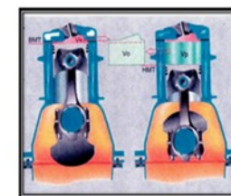
Рис. 4. Объемы поршневой камеры: V_0 – объем камеры сгорания, V_1 – рабочий объем цилиндра, V_2 – полный объем цилиндра, ВМТ – верхняя мертвая точка, НМТ – нижняя мертвая точка.
